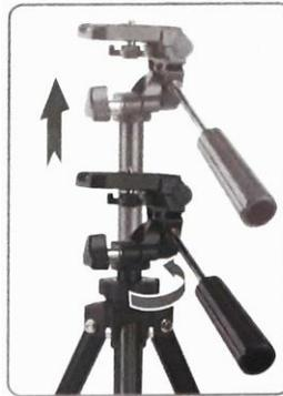
Para erguer a coluna central, afrouxe o botão de trava da coluna girando para a direita e ajuste a altura para a posição desejada. Certifique-se de travar a coluna girando em sentido contrário antes de soltar a câmera.
