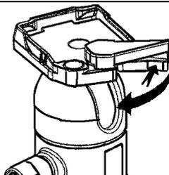
Para remover a placa, deixe a alavanca de inclinação da bola travada ou segure a base de engate. Aperte ao mesmo tempo a trava de segurança e a da placa e puxe a trava maior em sentido horário. A placa será desengatada, podendo ser removida.
