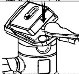
Engate a placa inserindo o lado com ângulo agudo na parte oposta às travas e pressione para encaixar. A trava irá voltar automaticamente.
